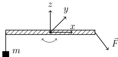
Ein Stab der Länge  $L = 1$  m sei in seiner Mitte um eine in  $y$ -Richtung zeigende Achse drehbar gelagert. An einem Ende des Stabes greife eine Kraft  $\vec{F} = (3, 0, -4)^T$  N an (siehe Skizze).
