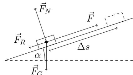
die Kraft  $F = 20 \text{ N}$ , mit der er nach oben gezogen wird, seine Gewichtskraft  $F_G$ , die Normal-Kraft  $F_N$ , die der Untergrund auf ihn ausübt und die senkrecht zur Oberfläche wirkt, und eine Reibungs-Kraft  $F_R = 10 \text{ N}$ , die der Bewegungs-Richtung entgegen wirkt. Berechnen Sie im Folgenden die Arbeiten, die von jeder einzelnen dieser vier Kräfte am Klotz geleistet werden. Welche Arbeit  $W_{\text{ges}}$  wird insgesamt von allen vier Kräften
