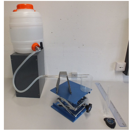
Abbildung 6.8: Versuchsaufbau zur laminaren Strömung.
