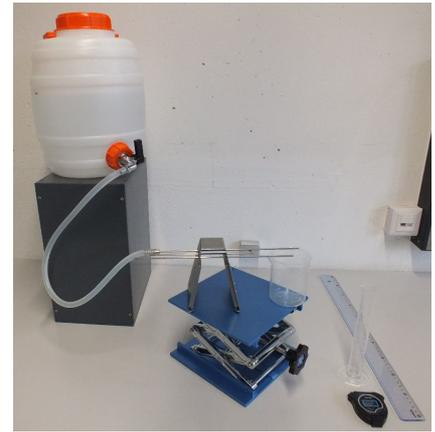
**Abbildung 6.8:** Versuchsaufbau zur laminaren Strömung.
