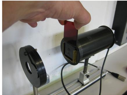
**Abbildung 9.15:** Haltevorrichtung für Farbfilter
