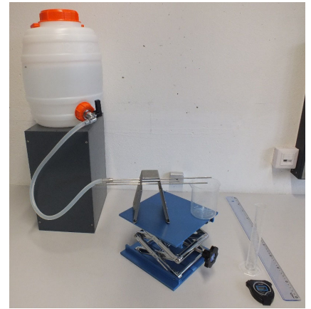
Abbildung 6.8: Versuchsaufbau zur laminaren Strömung.
