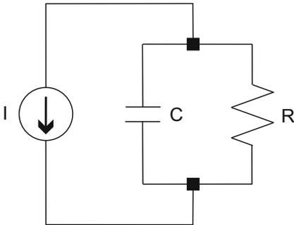
Abbildung 16.1: Parallelschaltung von Kondensator und Widerstand
