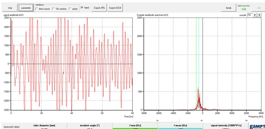
Abbildung 6.13: Deutlicher Peak im Dopplerspektrum bei optimaler Intensität.
