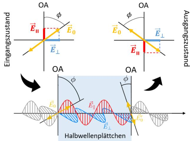
Abbildung 4: Polarisationsdrehung von Licht beim Durchlaufen eines Halbwellenplättchens.
