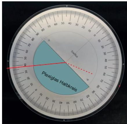
**Abbildung 9.12:** Halbkreis aus Plexiglas in Position für die Bestimmung des Brechungsindex von Plexiglas mit Hilfe der Totalreflexion
