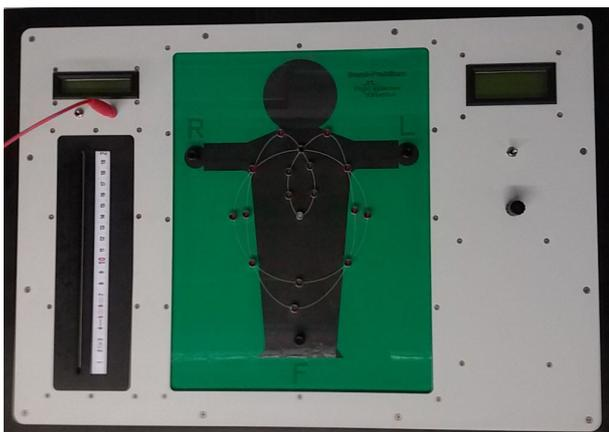
**Abbildung 15.12:** Brett zum Kennenlernen der physikalischen Grundlagen des Elektrokardiogramms. Das Brett ist aufgeteilt in drei Teilversuche: Links wird am Leiterstreifen der 1-dimensionale Dipol (Kippschalter auf linke Position), rechts wird in der Figur der 2-dimensionale Dipol (Kippschalterposition in mittlere Position) und die Herzschleife (Kippschalter auf rechte Position) vermessen.
