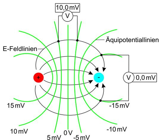
**Abbildung 15.2:** elektrische Feldlinien (schwarz) und Äquipotentiallinien (grün) eines Dipols; Spannungsmessungen an verschiedenen Punkten im Dipolfeld
