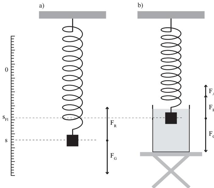
**Abbildung 3.4:** Jollysche Federwaage: a) Messung an Luft, b) Messung bei Eintauchen des Körpers in eine Flüssigkeit
