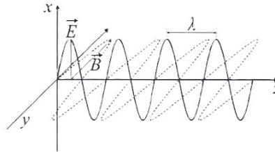
Abbildung 1: Modell der elektromagnetischen Welle
