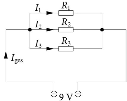
Abbildung 13.8: Parallelschaltung
