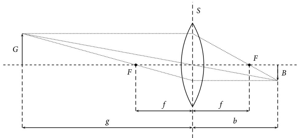
**Abbildung 9.4:** Konstruktion eines Bildes einer Sammellinse
