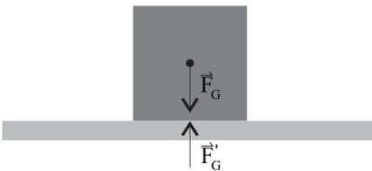
**Abbildung 3.1:** Kräfteschema für einen Körper auf einer Unterlage
