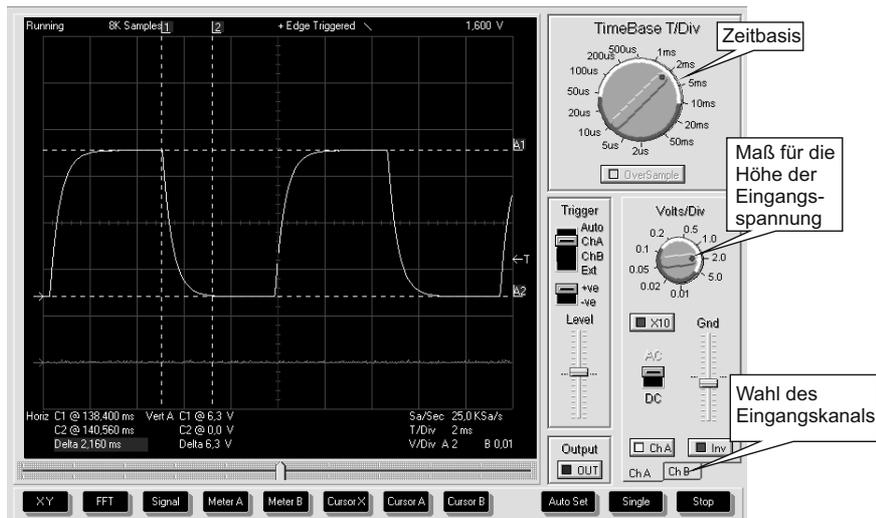
**Abbildung 16.6:** Darstellung der im Praktikum genutzten Oszilloskop-Software
