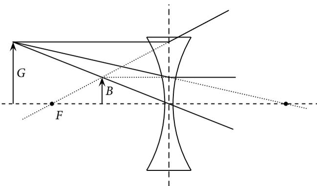
**Abbildung 9.5:** Konstruktion des Bildes einer Zerstreungslinse
