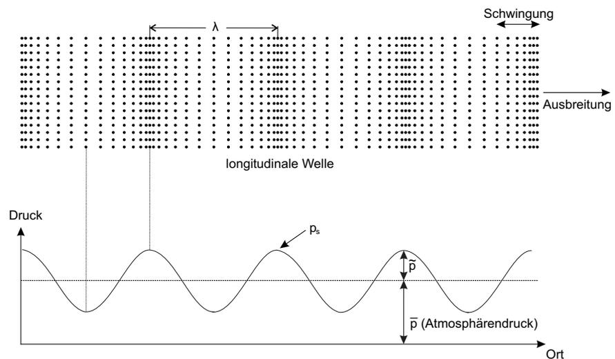
**Abbildung 17.1:** Ausbreitung von Schallwellen und die lokalen Druckunterschiede
