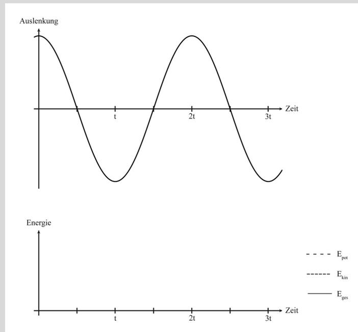
**Abbildung 3.6:** Verlauf von  $E_{pot}$ ,  $E_{kin}$  und  $E_{ges}$  bei gegebener Auslenkung.
