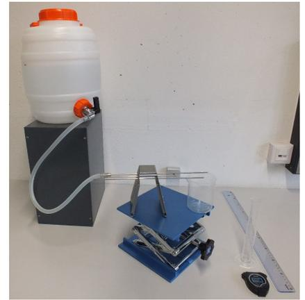
**Abbildung 6.8:** Versuchsaufbau zur laminaren Strömung.
