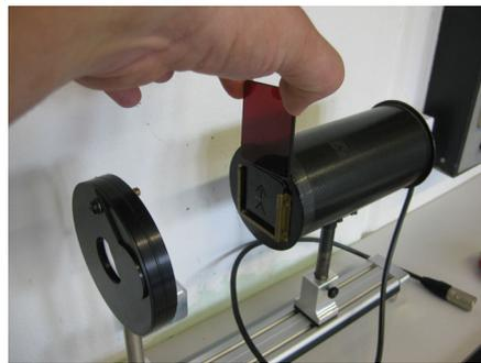
**Abbildung 9.15:** Haltevorrichtung für Farbfilter
