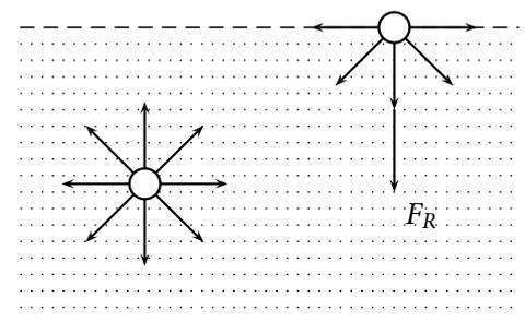
Abbildung 5.1: Oberflächenspannung
