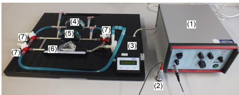
**Abbildung 6.9:** Versuchsaufbau: (1) Ultraschallgerät mit angeschlossenem (2) Ultraschallsender/-empfänger; (3) Pumpe; (4) Plexiglasblock mit 7 mm Durchmesser; (5) Plexiglasblock mit 10 mm Durchmesser; (6) undurchsichtiger PVC-Block mit Plexiglaskeil; (7) Ventile
