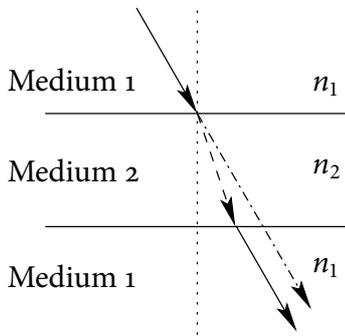
**Abbildung 9.2:** Parallelversatz des Lichts an einer dünnen Platte.
