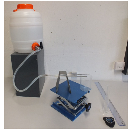
Abbildung 6.8: Versuchsaufbau zur laminaren Strömung.
