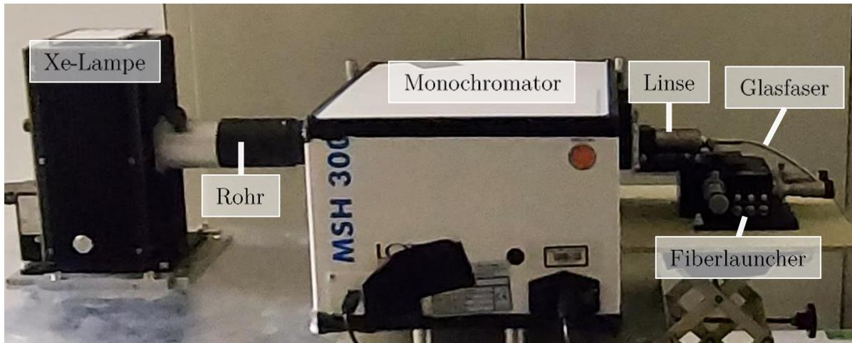
Abb. 5: Dies ist der Aufbau, mit dem das Licht einer Xenonlampe zunächst über ein Rohr in einen Monochromator gelangt, aus diesem Austritt, auf eine Linse trifft, von welcher das Licht fokussiert wird, bis es dann schließlich in eine Glasfaser eingekoppelt wird, welche an einem Fiberlauncher montiert ist. Das andere Ende der Glasfaser ist nicht zu sehen, dieses befindet sich in einem anderen Raum, und an ihm ist ein Kollimator angeschlossen.
