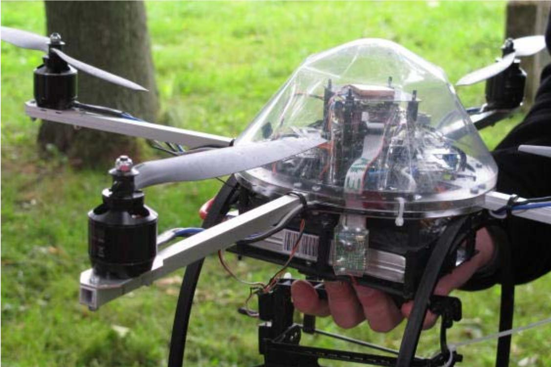
Durch das Auge einer Infrarot-Kamera an Bord erlaubt der ferngesteuerte Quadrocopter einen speziellen Blick aus der Vogelperspektive. Alle zwei Sekunden nimmt er ein Bild auf. (Foto: Annette Waschbüsch)
