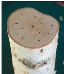
3. Nun werden Löcher in die Baumscheibe gebohrt. Jedes Loch sollte im rechten Winkel gebohrt werden. Außerdem sollte die Bohrmaschine die Baumscheibe nicht durchdringen.
