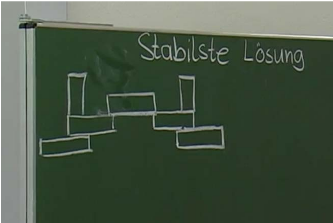
Tafelskizze „Kragbogenbrücke – stabilste Lösung“
