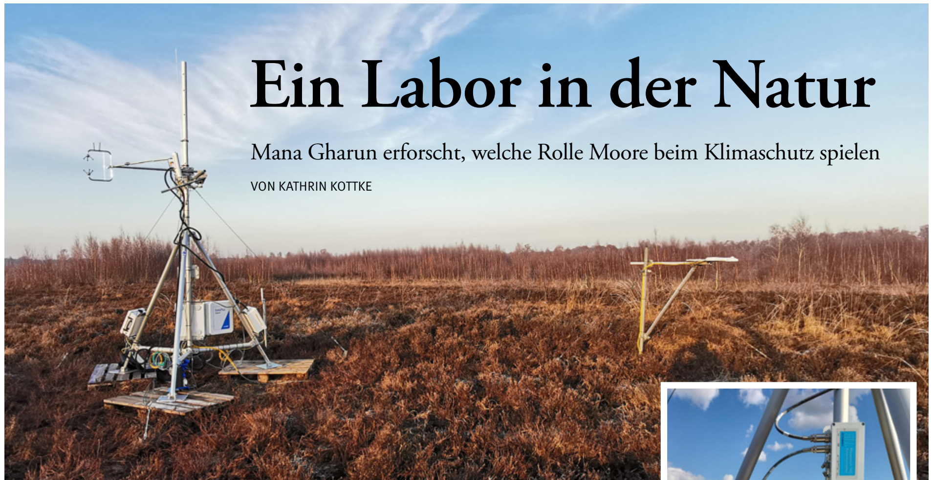
Im Amtsvenn-Hündfelder Moor steht ein sogenanntes ICOS-Eddy-Kovarianz-Messsystem. Es erhebt zahlreiche Daten, etwa zum Boden, Wetter und Klima. Die Informationen werden unmittelbar an die Uni-Server übermittelt.
