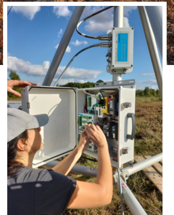
Im Amtsvenn-Hündfelder Moor steht ein sogenanntes ICOS-Eddy-Kovarianz-Messsystem. Es erhebt zahlreiche Daten, etwa zum Boden, Wetter und Klima. Die Informationen werden unmittelbar an die Uni-Server übermittelt.
