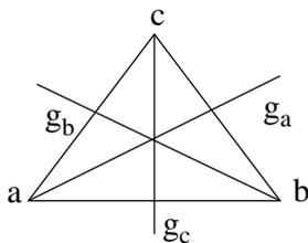
Die Symmetrieoperationen eines gleichseitigen Dreiecks sind  $\{S_a, S_b, S_c, D_{120}, D_{240}, D_{360} = D_0\}$ . Wobei  $S_i$  Spiegelungen an den Geraden  $g_i$  und  $D_\alpha$  Drehungen um den Winkel  $\alpha$  bezeichnen. In diesem Fall ist mit Invarianz die Deckungsgleichheit gemeint.
