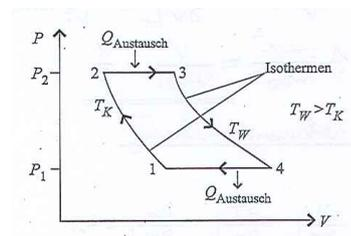
Ein ideales Gas durchlaufe den skizzierten Kreisprozess reversibel. Bei diesem sogenannten Ericsson-Prozess werden isotherme und isobare Zustandsänderungen durchgeführt, wobei die während der isobaren Kompression bzw. Expansion umgesetzten Wärmen gegeneinander ausgetauscht werden.
