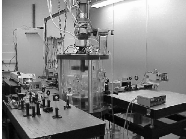
Abbildung 1.1: Experimenteller Aufbau zur Vermessung von Teilchentrajektorien. Im Gefäß in der Mitte wird durch gegenläufig rotierende Scheiben eine turbulente Strömung erzeugt, in der sich dichteneutrale Teilchen bewegen. Ein Laser beleuchtet die Teilchen, das gestreute Licht wird von Detektoren registriert. Entnommen aus [VLC + 02].
