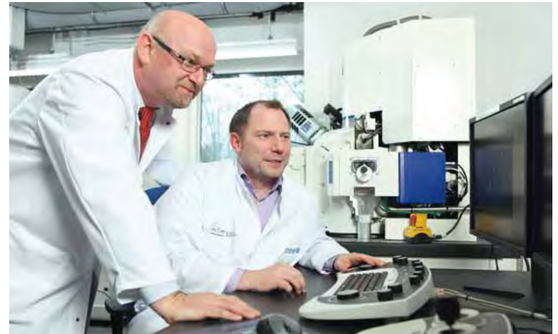
Mit Hilfe des Rasterelektronenmikroskops können Prof. Martin Winter und Dr. Falko Schappacher optische Veränderungen der Batterie-Elektroden beobachten. | Using the scanning electron microscope, Prof. Martin Winter and Dr. Falko Schappacher can observe optical changes in battery electrodes.
