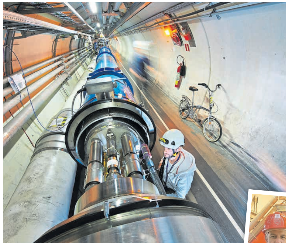
Der Large Hadron Collider (LHC), hier während des Stillstands, ist der weltweit größte und leistungsfähigste Teilchenbeschleuniger. Er besteht aus einem 27 Kilometer langen Ring aus supraleitenden Magneten mit einer Reihe von Beschleunigungsstrukturen. Foto: Maximilien Brice/Julien Ordan/CERN
