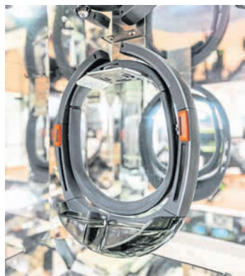
Die verspiegelte Desinfektionsanlage reinigt die Brillen mit UV-Licht.
