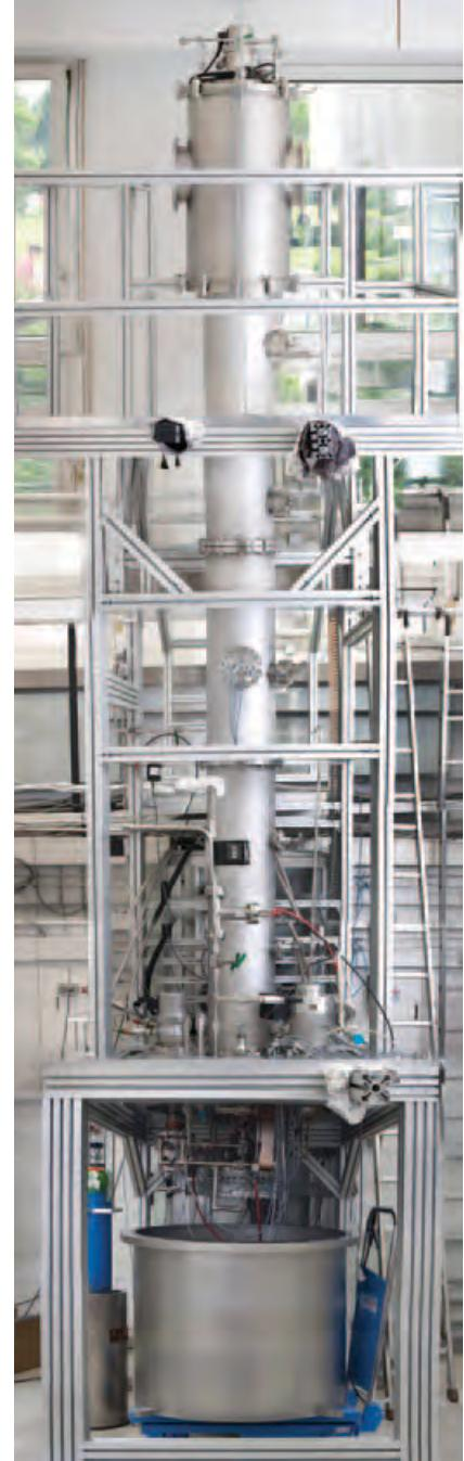
Die von WWU-Wissenschaftlern entwickelte, fünf Meter hohe kryogene Destillationssäule hält den Weltrekord in Xenongas-Reinheit. The five-metres high cryogenic distillation column, developed by Münster University scientists, holds the world record for xenon gas purity.
