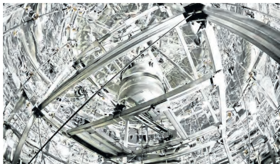
Das Herzstück des imposanten Experiments: Zu sehen ist ein zylinderförmiger Kryostat, der an einer Stahlkonstruktion inmitten eines riesigen Wassertanks hängt. Foto: XENON Collaboration
