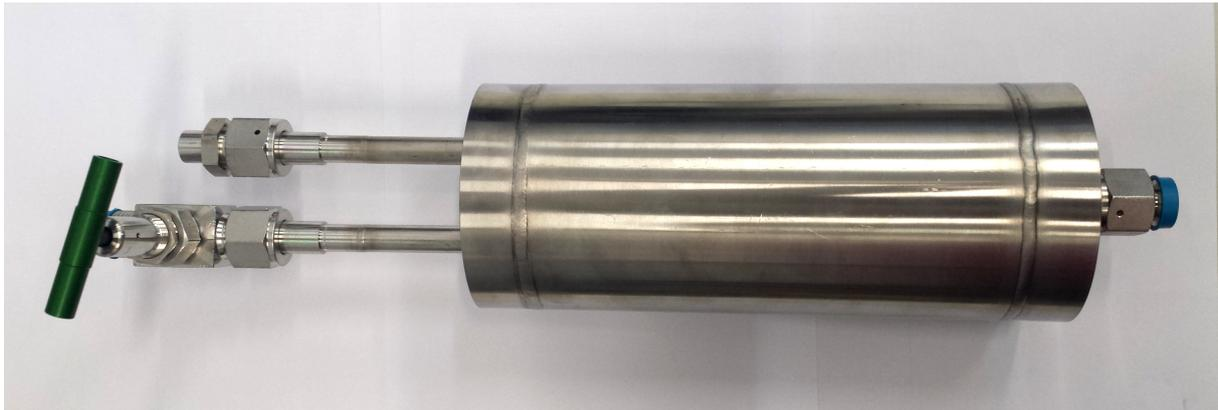
Abbildung 4.1.: Metallzylinder ( $V_3$ ) inklusive eines manuellen Ventils an einem der zwei am Boden angeschweißten Fittinge.
