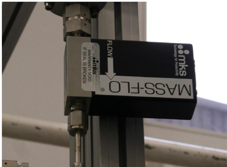
Abbildung 4.4.: Flowcontroller vom Typ MKS 1479B an der Off-Gas-Leitung.
