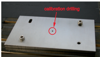
Abb. 4.18: 1. Schritt des Kammvermessungsprogramms. Der erste Schritt des Kammvermessungsprogramms dient der Kalibration der Kamera.
