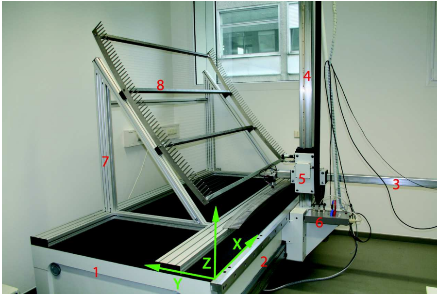
Abb. 4.2: Der Stiefelmayer-Messtisch nach dem Umbau. (1) Messtisch, (2) Schiene der x-Achse, (3) y-Achse, (4) z-Achse, (5) Führung der y-Achse, (6) Ausleseelektronik mit Spannungsversorgungen, (7) Halterung für die Elektrodenmodule, (8) Prototyp eines Zylindermoduls.
