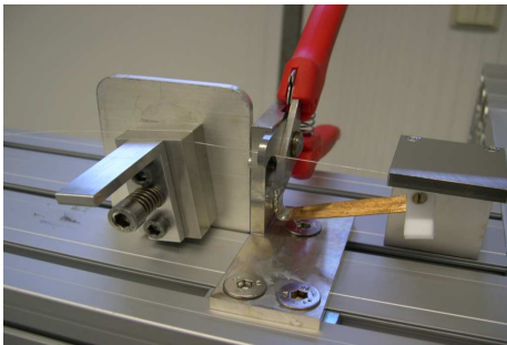
Abb. 6.11: Drahtschneidevorrichtung. Der Draht ist am Hebelarm mit einer speziellen Klemmvorrichtung befestigt und gespannt. Wird der Draht mit der Zange abgeschnitten, wird das Teflonplättchen am Bronzeblech gegen den Metallwinkel gedrückt und hält das lose Ende des Drahtes so fest.
