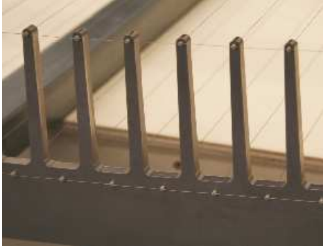
Abb. 3.7: Drähte im Modul. Zu erkennen sind die Keramikisolatoren, in denen die Drähte fixiert sind. Die beiden Drahtlagen sind um den halben Drahtabstand \frac{d}{2} gegeneinander verschoben.
