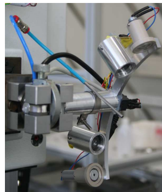
Abb. 4.32: Der Lasersensor am Arm der Messmaschine. Der Lasersensor ist an der Halterung des y-Arms der Maschine angebracht. Der blaue Schlauch dient der Zufuhr von Argon, um die Drähte in Schwingung zu versetzen.
