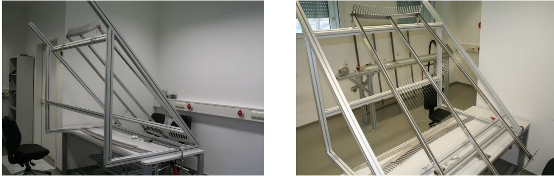
Abb. 6.13: Die Modulstation. Aufnahmen der Modulstation mit einem Konusmodul im Reinraum.
