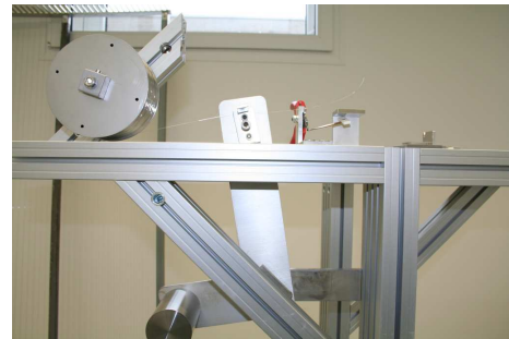
Abb. 6.12: Hebelarm mit Gewicht. Der Hebelarm ist am waagerechten Ausleger mit einem Gewicht beschwert, das für die passende Spannung des fixierten Drahtes sorgt. Ebenfalls zu sehen sind die Drahtspule und die Schneidevorrichtung.
