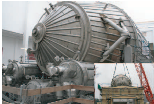
Abb. 3.10: Das Hauptspektrometer. Das große Bild zeigt das Hauptspektrometer, wie es kurz nach seiner Ankunft in Karlsruhe an seinem neuen Standort steht. In dem kleinen Bild ist der Einhub in seine endgültige Position zu sehen.
