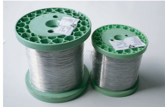
Abb. 5.2: Vogelsangdrahtspulen. Die zu untersuchenden Drähte sind auf Plastikrollen aufgewickelt. Je nach Drahtdurchmesser sind 3 kg oder 4 kg Material erhältlich.
