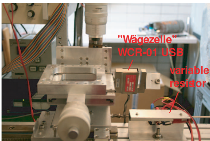
Abb. 5.11: Wägezelle und regelbarer Widerstand zur Aufnahme der Abreißkurven. Ein 1,80 m langer Draht wurde in eine spezielle Vorrichtung eingespannt. Die einwirkende Kraft wurde solange erhöht, bis der Draht gerissen ist. Die ausgeübte Kraft wurde mit Hilfe einer Wägezelle des Typs WCR-01 USB gemessen, während die Weglänge mit Hilfe eines Potentiometers ausgelesen wurde, dessen Widerstand sich proportional zur Auslenkung ändert.
