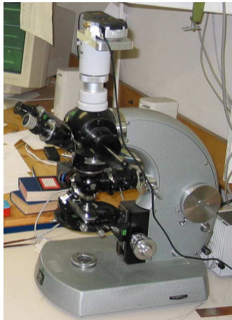
Abb. 5.1: Das Lichtmikroskop. Das auf dem Bild zu sehende Mikroskop wurde zur Untersuchung der Oberflächenbeschaffenheit der einzelnen Drähte verwendet.
