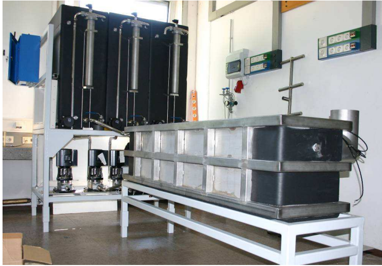
Abb. 4.3: Vollautomatische Ultraschall Reinigungsanlage. Ein etwa 2 m · 0,3 m · 0,4 m großer Tank stellt den Hauptbestandteil der Anlage dar, in dem die Bauteile mit Hilfe von Ultraschall gereinigt werden können. Die Reinigungsmittel werden über Pumpen aus den angrenzenden Behältern zu- bzw. abgeführt [Tem07].
