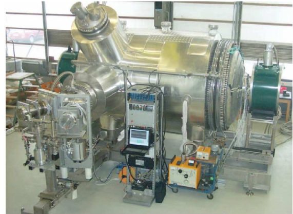
Abb. 3.8: Das Vorspektrometer [Kat04] . Links ist ein Schema des Vorspektrometers zu sehen. Das rechte Bild zeigt ein Foto des Vorspektrometers wie es nach der Montage des Heiz-Kühlungssystem am FZK steht.
