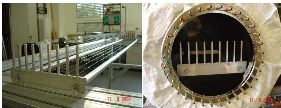
Abb. 5.15: Testrahmen und UHV-Ofen. Ein speziell für den UHV-Ofen konstruierter Testrahmen wird zur Überprüfung der thermischen Eigenschaften der Drahtmaterialien verwendet.
