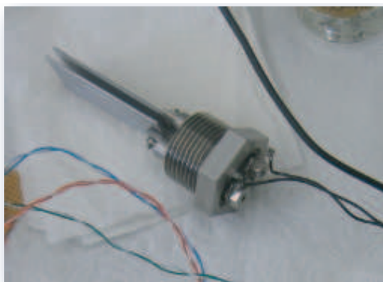
Abbildung 6.8: Foto eines Füllstandssensors. Der Werkstoff für diesen Sensor ist Edelstahl und Plastik, damit er in Kombination mit Ultraschall und den verschiedenen Lösungsmitteln eingesetzt werden kann.
