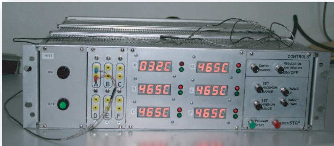
Abbildung 8.5: Frontansicht der Heizsteuerung. An Kanal A ist ein PT100-Sensor angeschlossen, dessen Temperatur in Grad Celsius angezeigt wird.
