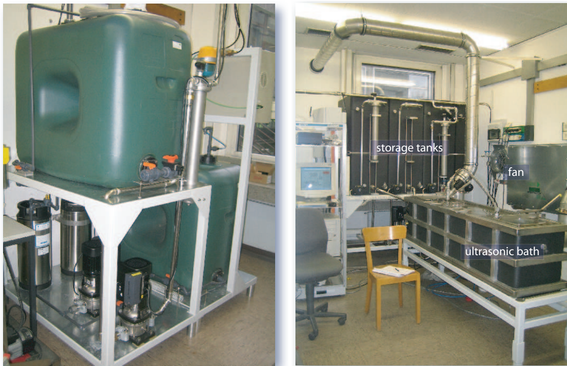
Abbildung 5.3: Fotos des Gesamtaufbaus der Ultraschallanlage. Links: Reinstwasseranlage mit Förderpumpen; rechts: Vorratstanks und Ultraschallwanne.
