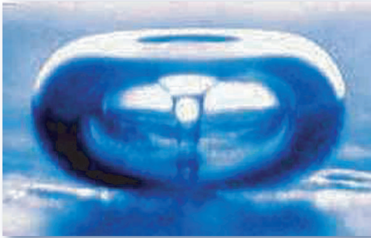
Abbildung 4.2: Momentaufnahme einer Kavitationsblase während der Implosion an einer Oberfläche. Man erkennt deutlich in der Mitte den Microjet, der die Schmutzpartikel an der Oberfläche effizient absprengt [Sus89].
