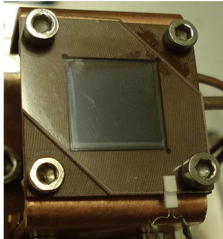
Abb. 4.6: Photodiode RMD S1315 in einer im Rahmen dieser Arbeit konstruierten Halterung. Die technische Zeichnung dieser APD findet sich in Anhang E.
