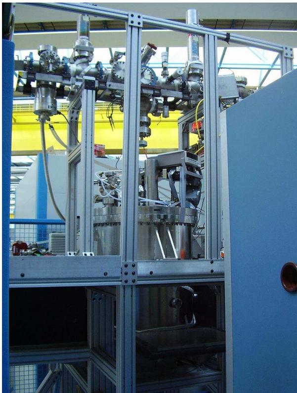
Abb. 2.3: Der SpecTrap-Tank (unten) und die Ionenzuführung (oben)
