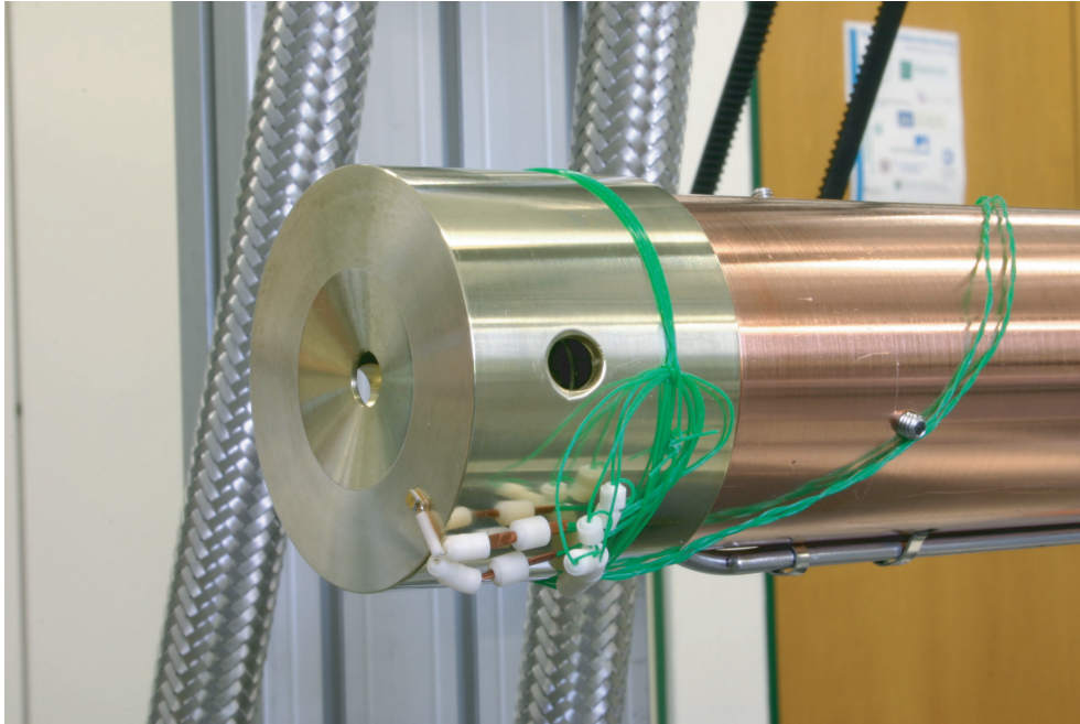
(a) Das vordere Ende des Kaltfingers. Zu erkennen ist das 40K Kaltschild mit einem Temperatursensor. Die grüne Ummantelung der Signalleitung besteht aus Teflon. Unterhalb des Kaltfingers sieht man ein Stück der Kapillare. Zentral auf dem 40K Schild ist eine Öffnung für die Ellipsometrie und die Laserablation zu erkennen.
