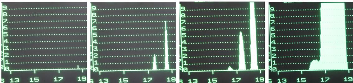
Abb. 5.9: Aufnahme der Massenspektren bei Potenziometereinstellungen 5,9; 6,2; 6,6 und 7,5.
