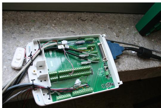
Abb. 3.7: Anschlussblock NI SCC-68 nach der Bearbeitungszeit der Bachelorarbeit. Zum einen wurden weitere Geräte angeschlossen, zum anderen wurden die vorhandenen Kabel durch abgeschirmte Kabel ersetzt. Links ist der Schalter der Turbopumpe zu sehen.
