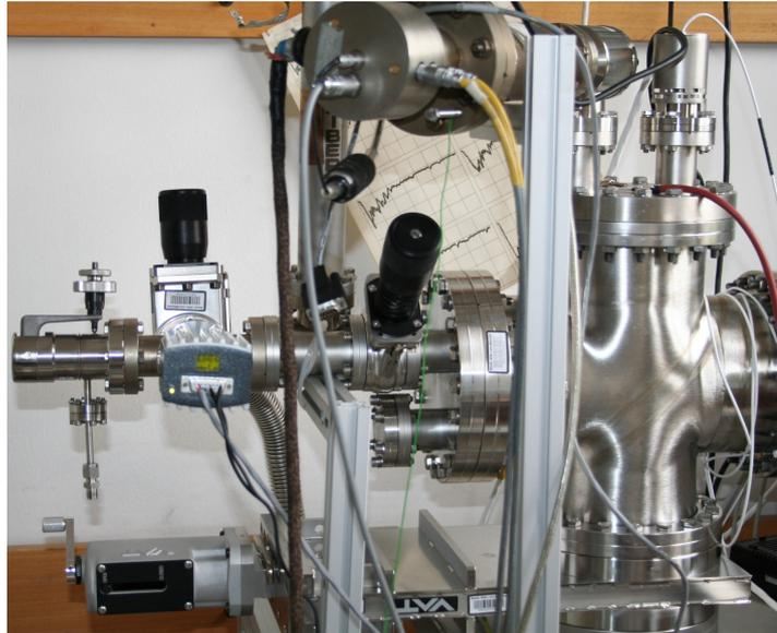
Abb. 3.3: Foto des Vakuumstands. Rechts sieht man die Hauptkammer, an die oben ein Vakuummeter sowie ein Massenfilter angebracht ist. Links liegt die Nebenkammer hinter der anderen Druckmessröhre. Zwischen Haupt- und Nebenkammer liegt die differentielle Pumpsperre und links neben der Nebenkammer das Dosierventil V8. Ganz unten links im Bild ist das Schiebeventil V5 zu sehen, mit dem die Hauptkammer von der Turbopumpe getrennt werden kann.
