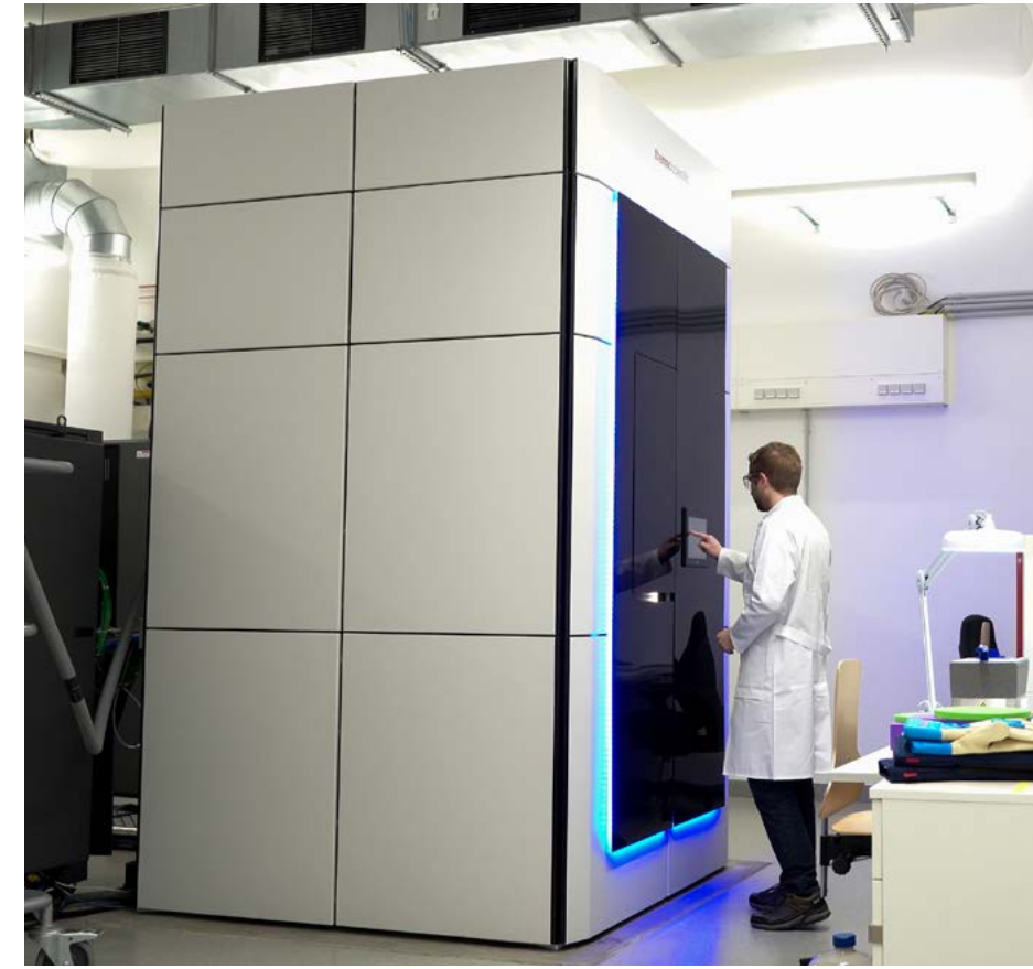
Das Kryoelektronenmikroskop ist durch eine Verkleidung abgeschirmt, sodass von der Hochleistungstechnik nichts zu sehen ist. Foto: WWU - Sophie Pieper
